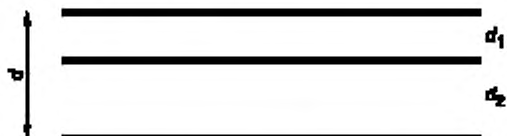
D — общая толщина изоляции; d_1 — величина изоляционного промежутка; d_2 — толщина твердой изоляции
