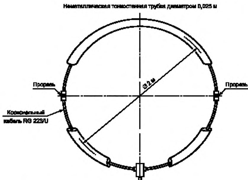
Рисунок С.2 — Большая рамочная антенна с двумя противоположными прорезями, расположенными симметрично относительно токосъёмника С
