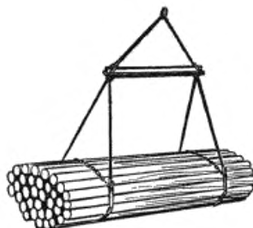
Рисунок 7 — Схема строповки длинномерного груза
