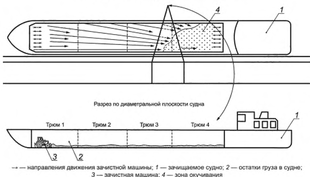
Рисунок 2 — Схема использования зачистной машины
