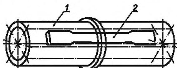
1 — патрубок со сварным соединением; 2 — расположение образцов
