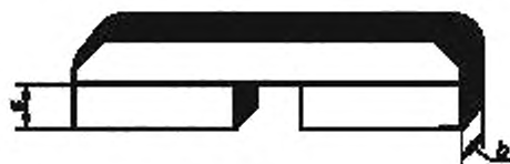
Образец, выполненный нагретым инструментом в раструб
