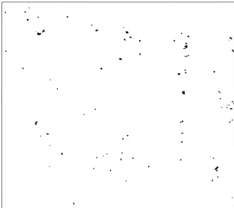
Рисунок Ж.2 — Коррозия металла, балл K2 (или R/2)
