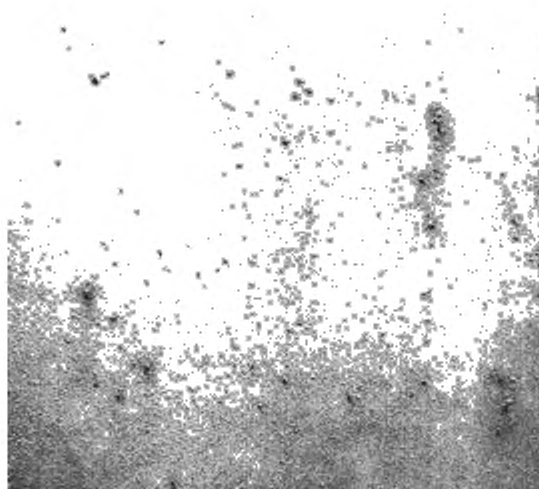
Рисунок 10 — Коррозия металла балл K2 (или R2)
