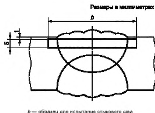
Рисунок 6 — Изготовление из контрольного образца продольных образцов для испытания
