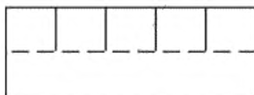
Рисунок А.2 – Пример раскроя стеклянного мата для угловой раскладки
