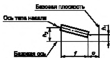
Рисунок 3 — Допустимое смещение оси тела накала 12)
