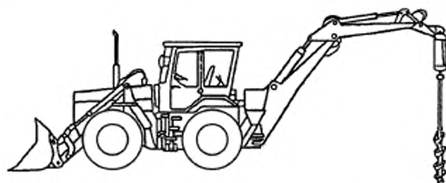
Рисунок В.5 — Экскаватор-погрузчик с буровым сменным рабочим оборудованием
