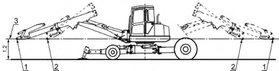
Рисунок 1 — Линии опрокидывания шагающего экскаватора
