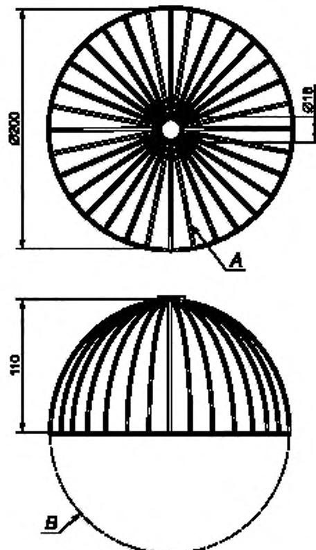
А — каркас из 32 равномерно расположенных проволок диаметром  $(1,5 \pm 0,5)$  мм;
