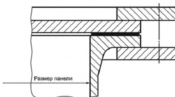
Рисунок Е.6 — Крепления в соответствии с типом 2: фланцевая заглушка с патрубком и подкладными кольцами
