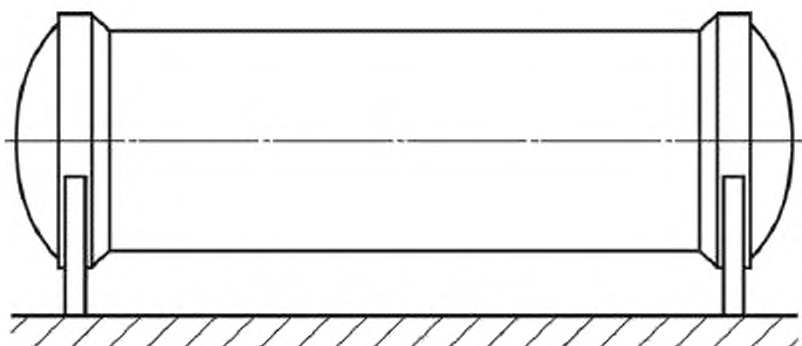
Рисунок 9.4 — Хранение емкости на двух опорах
