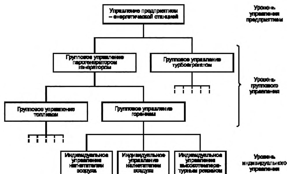
Рисунок А.6 — Уровни управления энергетической станцией (ТЭЦ)
