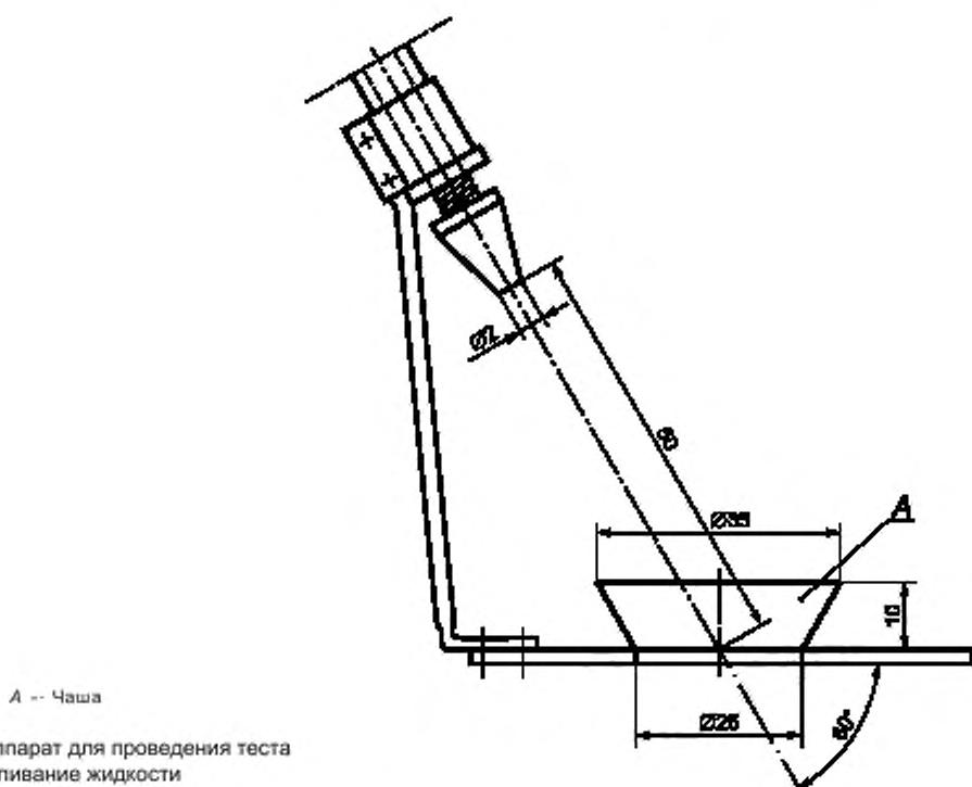
Рисунок 101 — Аппарат для проведения теста на пропивание жидкости
