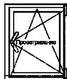
Рисунок А.4 — Поворотное (откидное, поворотнo-откидное) устройство с функцией регулируемого проветривания
