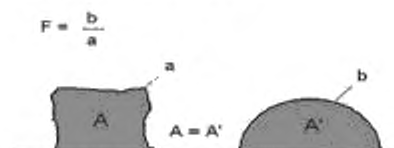
A — тень области образца (фактическое изображение); A' — площадь образца после компьютерной оценки изображения (эквивалент теневой площади); a — реально измеряемый контур, b — идеальный контур
