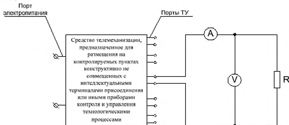
Рисунок 2 – Схема проверки параметров сигнала ТУ
