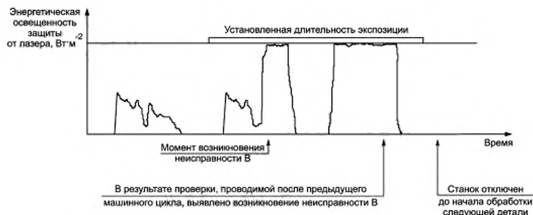
Рисунок В.6б — Отключение лазера при использовании автономного машинного мониторинга безопасности
