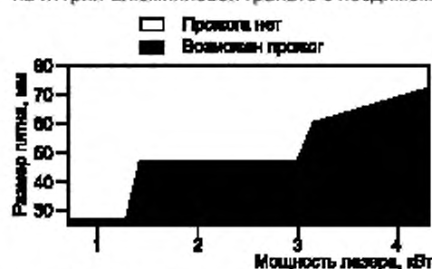
Рисунок F.22 — Стойкость к разрушению листа нержавеющей стали толщиной 1 мм от 100 с экспозиции расфокусированного пучка во время экспериментов с использованием непрерывного лазера на иттрий-алюминиевой гранате с неодимом
