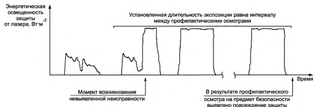
Рисунок В.7 — Установленная длительность экспозиции для станков без системы мониторинга безопасности
