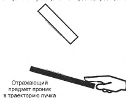
Рисунок В.4с — Расширенный пучок превышает размер границ оптической системы
