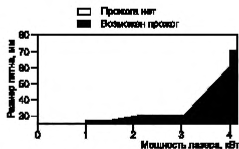
Рисунок F.13 — Стойкость к разрушению листа оцинкованной стали толщиной 1 мм от 10 с экспозиции расфокусированного пучка во время экспериментов с использованием непрерывного лазера на иттрий-алюминиевой гранате с неодимом
