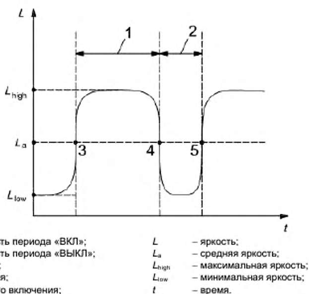
Рисунок 5 – Измерение частоты мигания
