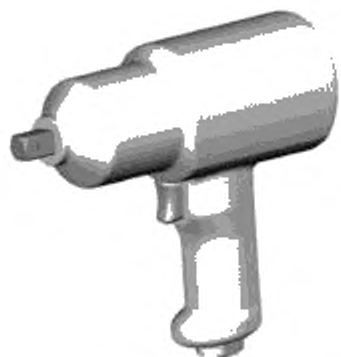
Рисунок 1 — Ударный/импульсный гайковерт с рукояткой пистолетного типа
