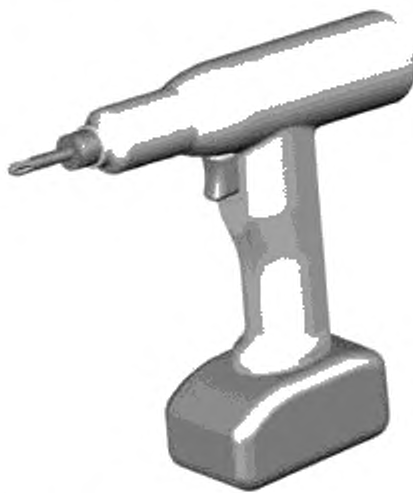
Рисунок 10 — Шурупверт с централизованной рукояткой пистолетного типа
