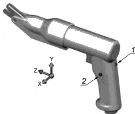
Рисунок 7 — Точки и направления измерений для ножевых ножниц с прямой рукояткой пистолетного типа
