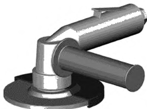
Рисунок 3 — Пневматическая угловая шлифовальная машина с корпусом пневмодвигателя в качестве основной рукоятки
