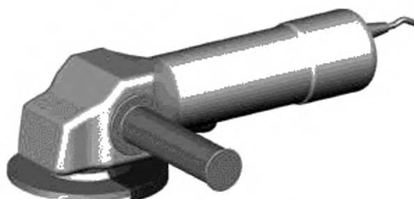
Рисунок 2 — Электрическая угловая шлифовальная машина с корпусом электродвигателя в качестве основной рукоятки
