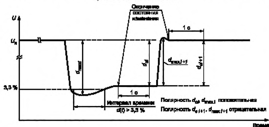
Рисунок В.2d — Пример для объяснения последовательности и полярности d_{\max} и d_c при многократных установившихся состояниях
