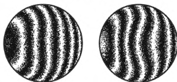
Рисунок 7 — Интерферограммы испытуемых объектов без заметных aberrаций
