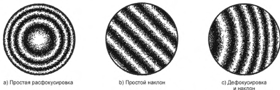
Рисунок 7 — Интерферограммы испытуемых объектов без заметных aberrаций
