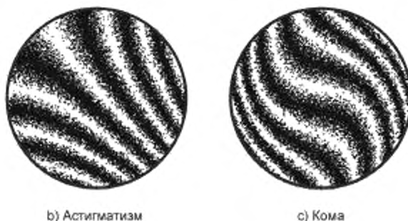
Рисунок 8 — Интерферограммы контролируемых систем при наличии небольших aberrаций
