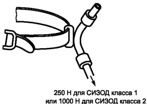
Рисунок 6 — Схема испытания прочности шланга подачи воздуха
