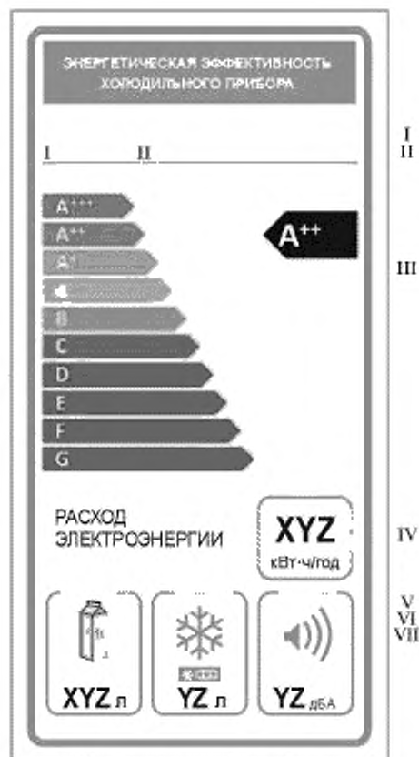
Рисунок А.2 — Вид этикетки энергетической эффективности холодильного прибора, классифицированного от D до G
