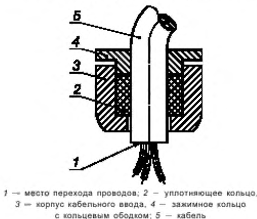
Рисунок 1 — Места ввода и перехода кабеля
