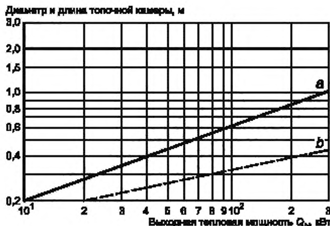
Рисунок D.1 — Минимальные размеры топочной камеры
