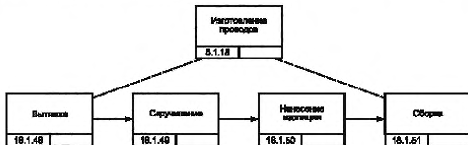
Рисунок В.6 — Блок-схема процесса изготовления проводов для изделия GT-350 [8]
