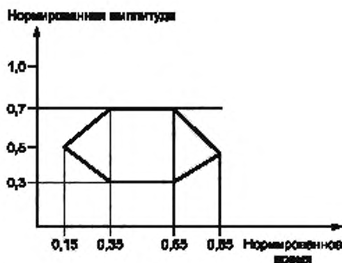
Рисунок 20 — Маска глазковой диаграммы передатчика при измерении джиттера
