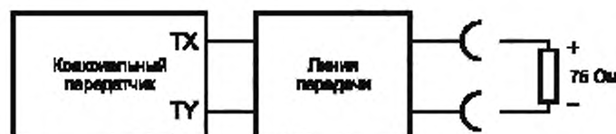
Рисунок 19 — Схема испытаний коаксиального передатчика
