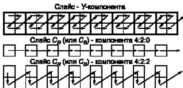
Рисунок А.6 — Порядок сканирования блоков в слейсе при кодировании трансформант — постоянных составляющих
