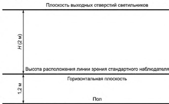
Рисунок 4 — Размеры стандартного модуля в разрезе
