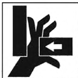
Рисунок A.21 — Раздавливание пальцев или кисти. Силовое воздействие со стороны
