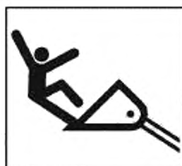
Рисунок А.8 — Падение с поднятого ковша погрузчика
