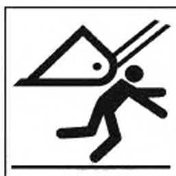
Рисунок A.17 — Раздавливание тела. Поднятый ковш или стрела погрузчика
