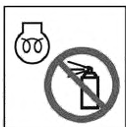
Рисунок В.22 — Не используй дизельный эфир. Пользуйся устройством для холодного пуска
