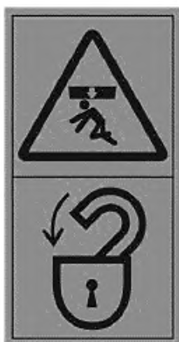
Рисунок С.9 — Раздавливание тела. Установи блокирующее устройство перед входом в опасную зону
