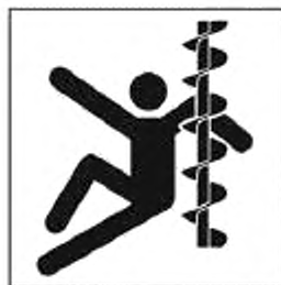
Рисунок А.33 — Затягивание кисти и руки. Шнек
