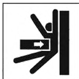
Рисунок A.18 — Раздавливание тела. Однонаправленный шкворень
