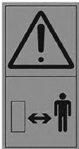
Рисунок С.1 — Стой на безопасном расстоянии от источника опасности. Общее обозначение
