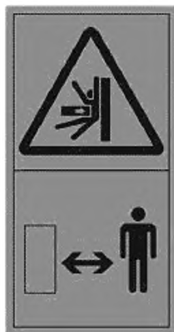
Рисунок С.4 — Раздавливание тела или проникающее ранение. Стой на безопасном расстоянии от источника опасности
