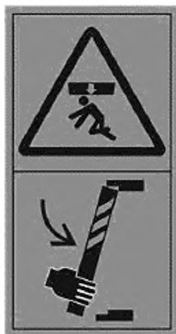
Рисунок С.8 — Раздавливание тела. Установи опору перед входом в опасную зону
