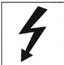
Рисунок А.2 — Электрошок или поражение электрическим током. Общее обозначение
