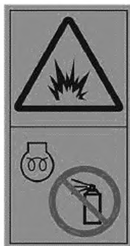
Рисунок С.20 — Опасность взрыва. Не используй диэтиловый эфир. Применяй устройство для холодного пуска
