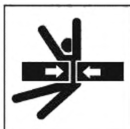
Рисунок A.16 — Раздавливание тела. Двухнаправленное силовое воздействие
