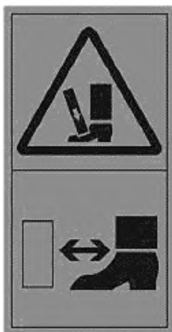
Рисунок С.28 — Раздавливание ног. Держись на безопасном расстоянии от источника опасности
