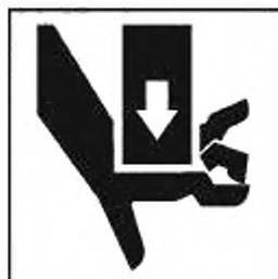
Рисунок A.22 — Раздавливание пальцев или кисти. Силовое воздействие сверху
