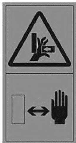
Рисунок С.29 — Раздавливание пальцев или кистей. Держись на безопасном расстоянии от источника опасности
