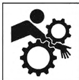
Рисунок A.31 — Затягивание кисти и руки. Вращающиеся шестерни
