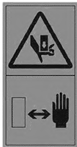
Рисунок С.29 — Раздавливание пальцев или кистей. Держись на безопасном расстоянии от источника опасности
