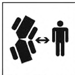
Рисунок В.6 — Стой на безопасном расстоянии от зоны поворота машины с шарнирно-сочлененной рамой
