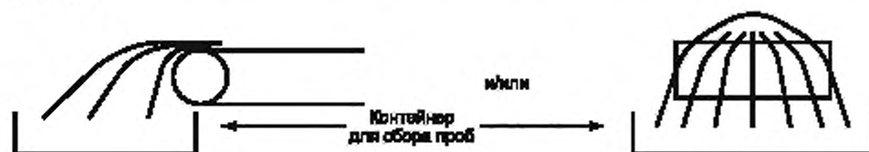
Рисунок Д.1 — Схематичное изображение падающего потока
