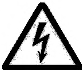
Рисунок 1 — Маркировка оборудования на напряжение класса Б
