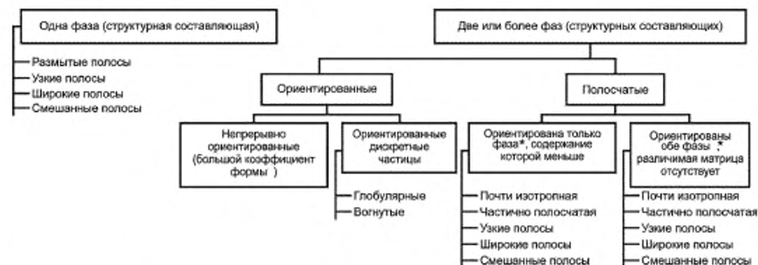
Рисунок 2 — Схема качественной классификации для ориентированных или полосчатых микроструктур
