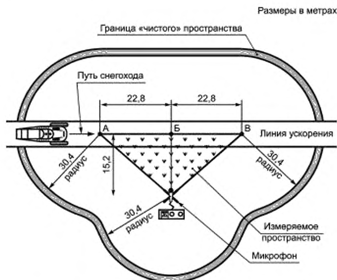
Рисунок 5 — Схема измерительного участка для определения внешнего шума
