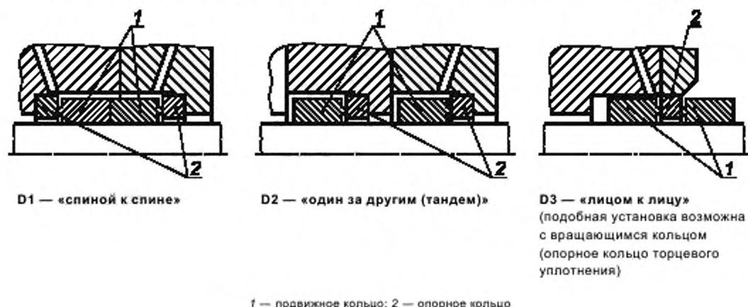
Рисунок F.3 — Примеры компоновок составного торцевого уплотнения
