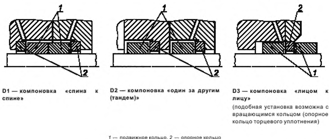
Рисунок Е.3 — Примеры компоновок составного торцевого уплотнения
