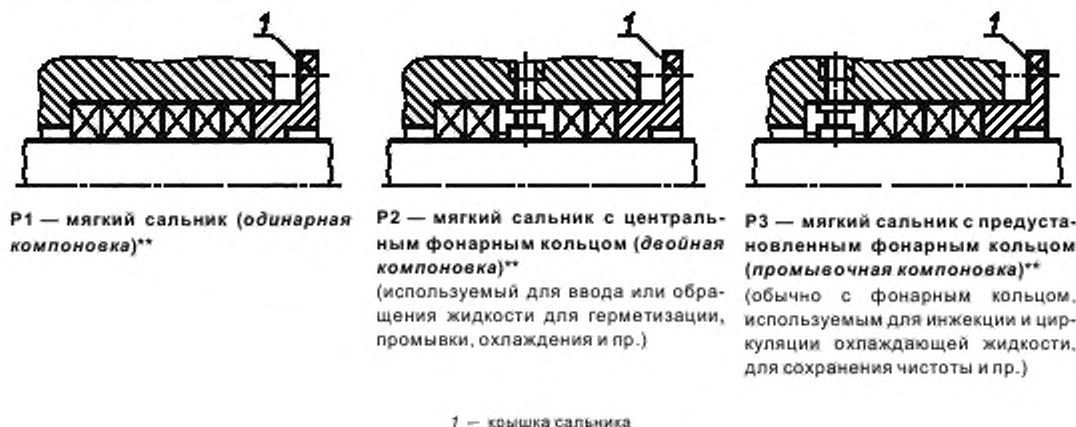
Рисунок Е.1 — Примеры компоновок мягкого сальника
