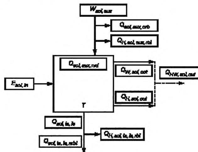
$T$  — подсистема генерации тепла системы солнечного теплоснабжения;
