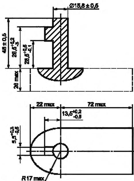
П р и м е ч а н и е — Бородок ключа должен по всему контуру свободно входить в гнездо и обеспечивать запирание фиксирующего устройства.
