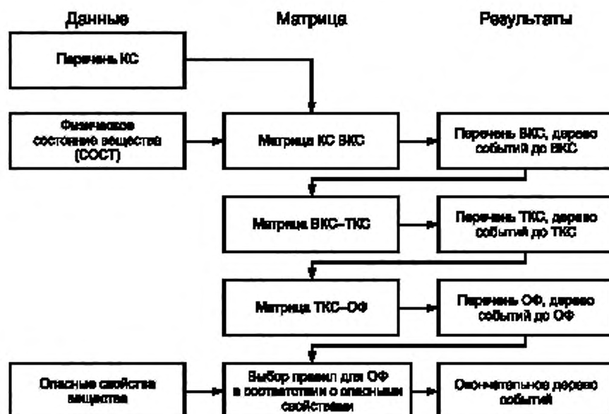
Рисунок 4 — Схема шагов построения дерева событий
