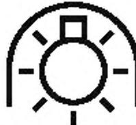
**A.3 Символ для лампы с дихроичным отражателем**
