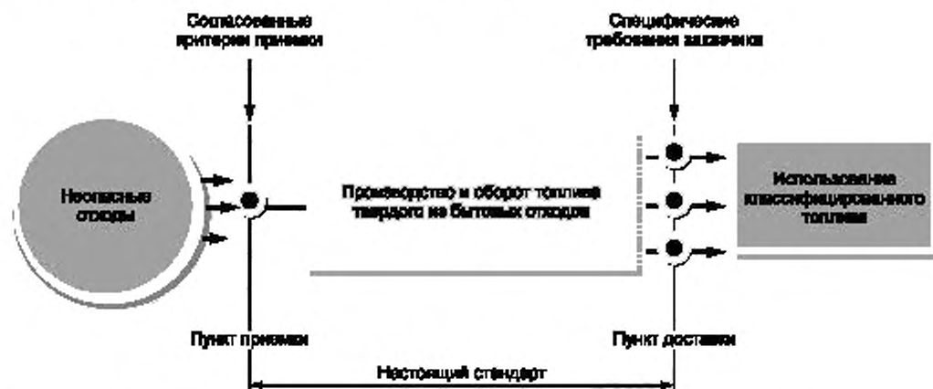
Рисунок 1 — Связь между отдельными элементами в области утилизации неопасных отходов, производства и обращения топлива твердого из бытовых отходов и его преобразования в энергию для конечного потребления
