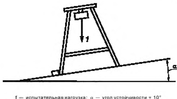
Рисунок 15 — Испытание на устойчивость для стационарных свободностоящих подъемников
