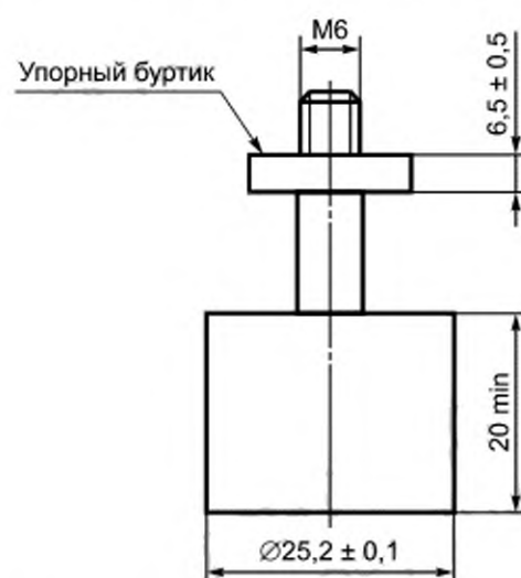
Рисунок 3 — Испытательный штамп площадью основания 500 мм 2
