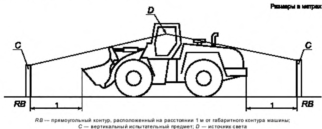
Рисунок 4 — Измерения в прямоугольном контуре, расположенном на расстоянии 1 м от габаритного контура
