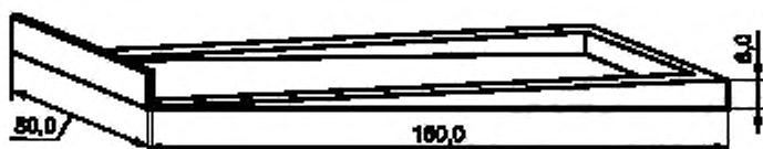
Рисунок 1 — Форма-рамка для изготовления образцов при определении устойчивости к образованию усадочных трещин
