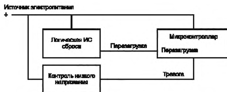
Рисунок А.10 — Структурная схема одноканального модуля защиты от пониженного напряжения
