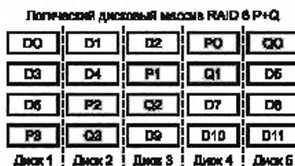
Рисунок А.7 — Структура размещения блоков данных (D) и блоков проверки (P и Q) в системе RAID 6
