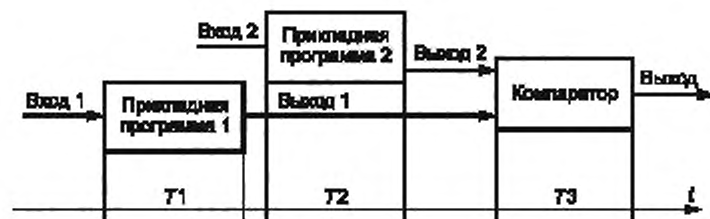
Рисунок А.3 — Компаратор одноканальной системы, реализуемый с помощью ПО
