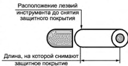
Рисунок 1 — Длина волокна, на которой снимают защитное покрытие
